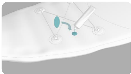
Appliquez une couche de colle sur la rustine et sur la surface endommagée
