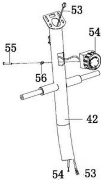
Munissez-vous du support vertical (pièce n°42) puis installez-y le bouton de réglage de résistance (pièce n°54) avec une rondelle incurvée (pièce n°56) et une vis à tête bombée (pièce n°55). Vissez ensuite avec la clé cruciforme (pièce n°63) pour bien serrer.
