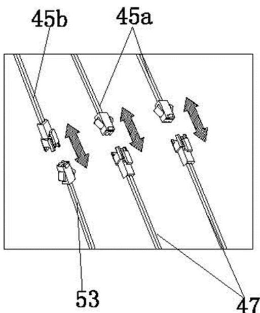
Introduisez le câble (pièce n°47) du guidon composé de deux têtes dans le trou (pièce n°68) de la structure comme sur le schéma explicatif puis faites-le remonter jusqu'à le sortir par le haut du tube vertical (pièce n°42). A ce moment, vous vous retrouvez avec 2 câbles et 3 connecteurs qui sortent du tube.
