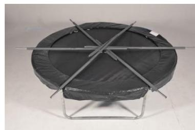
3. Fixez chaque perche sur l'armature du trampoline. Utilisez les pièces de l'inventaire du sachet de vis pour le filet de sécurité (P). Passez les 2 vis (P1) dans les emplacements de la perche G. De l'autre côté, mettez l'embout en plastique (P4), passez l'ensemble dans l'armature existante, ajoutez la rondelle (P2), puis l'écrou (P3), et vissez l'ensemble à l'aide d'une clef (P5).
