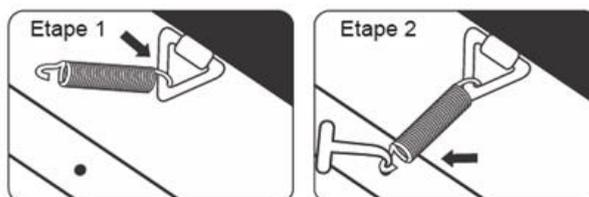
2. Répétez le processus pour chaque ressort (D) en suivant **IMPÉRATIVEMENT** les schémas ci-dessous en fonction de la taille de votre trampoline.
