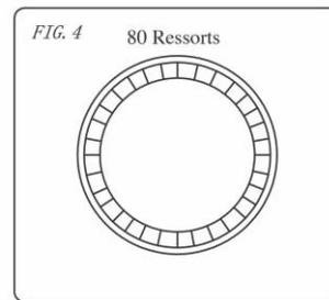
Il faut toujours mettre les ressorts les uns en face des autres afin de ne pas tordre le châssis et assurer une tension égale entre les ressorts lors du montage.
