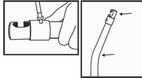
4. Emboîtez maintenant les perches du haut (J) aux perches du bas (I) déjà fixées sur le trampoline puis insérez les chaussettes de perches (M) sur les perches (I/J).
