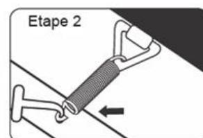
2. Répétez le processus pour chaque ressort (D) en suivant **IMPERATIVEMENT** les schémas ci-dessous en fonction de la taille de votre trampoline.
