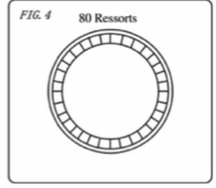
Il faut toujours mettre les ressorts les uns en face des autres afin de ne pas tordre le châssis et assurer une tension égale entre les ressorts lors du montage.
