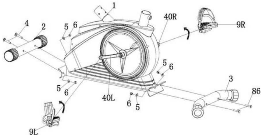
Fixer la base avant (2) à la structure principale (1) à l'aide des 2 vis M8\*73 (4), 2 rondelles (5) et 2 écrous (6). Utilisez la clef B pour serrer.
