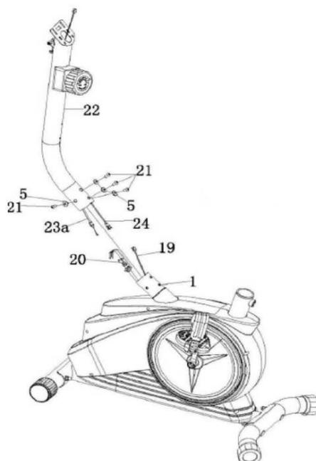
Connecter le câble de fréquence cardiaque (24) du support de guidon (22) avec celui du bas (19) de la structure principale (1).
