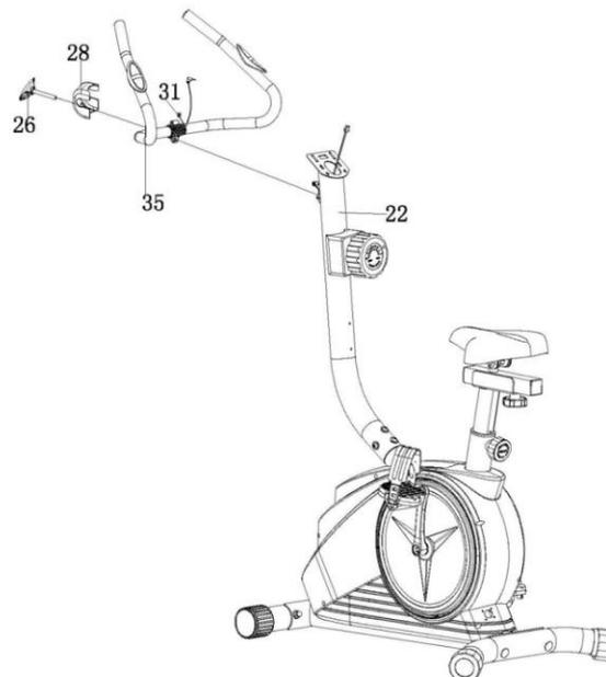
Vissez le guidon (35) au support de guidon en vissant le cache plastique (28) avec la vis M8 (26).
