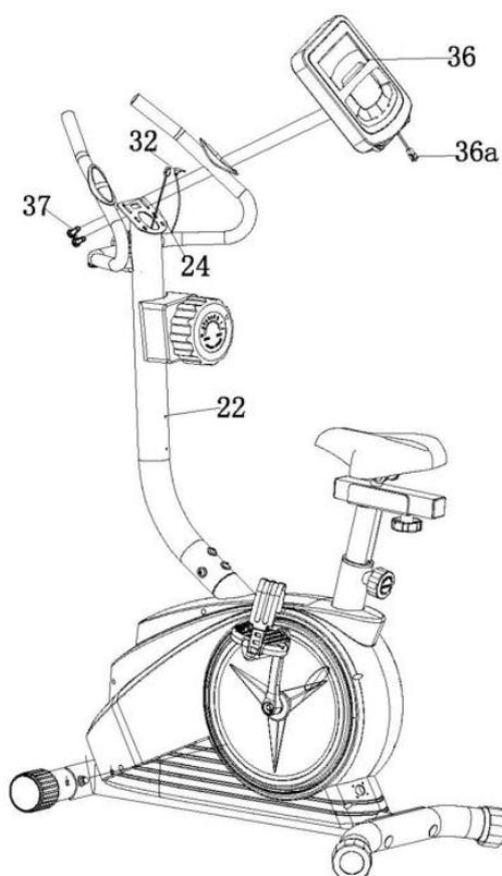
Connecter le câble du moniteur (36a) avec le câble de fréquence cardiaque (24).
