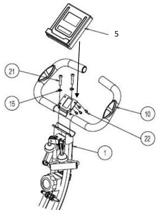
Brancher enfin les câbles à l'arrière du cadran numérique (5) à ceux du châssis en respectant les branchement Mâles et Femelles.
