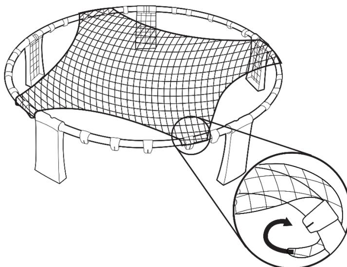
Placez ensuite le filet sur chaque clip. Pour tendre ou retendre le filet, il suffit d'ajuster la position en ramenant plus de fil sur les clips.
