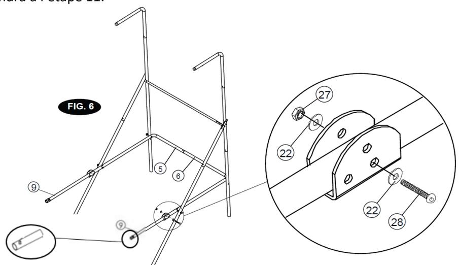
Fixez les tubes de rampe en L (10) sur les tubes de rampe (9).
