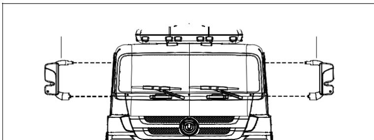
Fixez les rétroviseurs aux endroits prévus à cet effet. Appuyez fermement pour entendre le « clic d'installation ».
