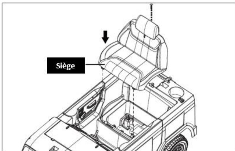
Installez le siège, insérez les 2 crochets de l'avant du siège sur la structure du véhicule puis vissez le siège à l'aide d'une vis sur l'arrière du siège.
