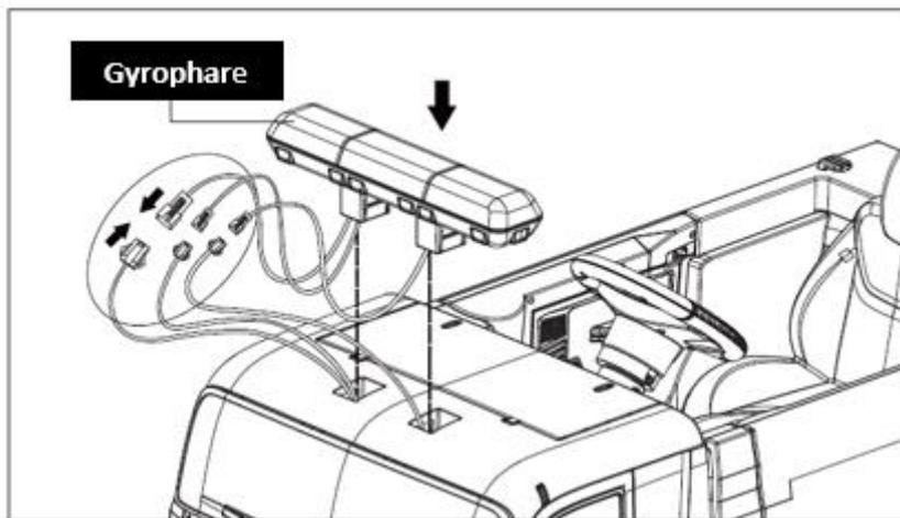
Connectez les fils du gyrophare aux fils présent sur l'avant du véhicule, veillez à faire correspondre les couleurs. Fixez le gyrophare sur le véhicule.
