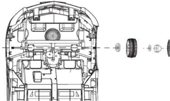
Pour les roues motrices arrières, le procédé est quasi identique : Vérifiez que l'essieu soit déjà présent, dans le cas contraire installez-le (voir schéma ci-dessous). Aussi la rondelle située entre le moteur et la roue est absente.
