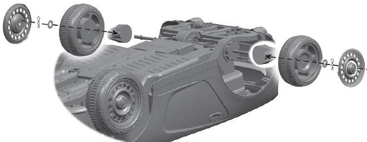
Imbriguez la roue dans le moteur déjà installé. Fixez la roue avec une rondelle, puis insérez une épingle dans le trou pour faire tenir la rondelle et la roue. Tordez l'épingle afin que celle-ci reste en place. Enfin, placez l'enjoliveur sur la roue.
