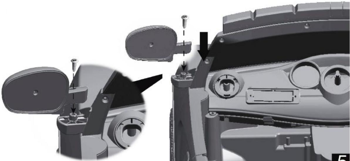
Installez les rétroviseurs dans les emplacements prévus (voir illustration), fixez-les à l'aide des vis (pcs 5) et d'un tournevis (non inclus).
