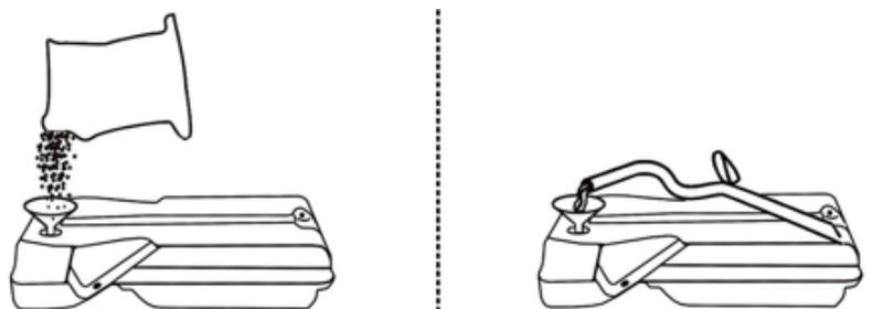
N.B. : Cette base étant creuse, nous conseillons de remplir la base d'eau puis de poser un sac de sable par-dessus afin d'augmenter la stabilité.
