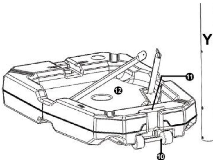
Fixez les bras de support (9) de chaque côté de la base (12) grâce aux 2 vis, rondelles et écrous (16). **Attention ! Veillez à bien distinguer le bras de support gauche et droit avant de les fixer. Les extrémités doivent bien épouser la forme de la base ou du poteau.**
