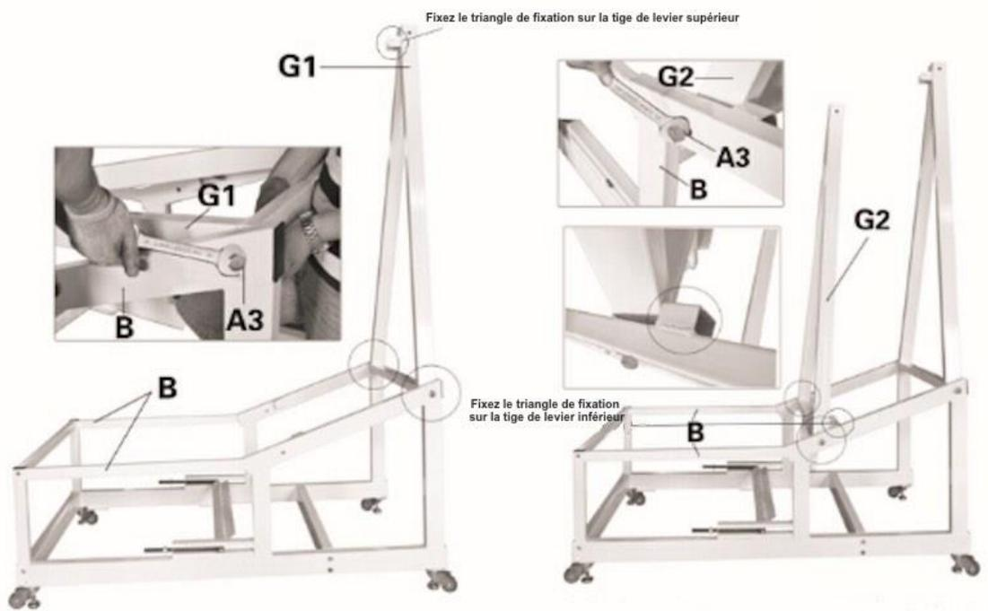
N.B : Sur chaque côté de la structure de base B il y a une tige de sécurité afin d'éviter une chute du triangle G2.
