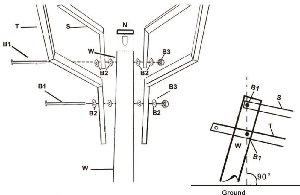
Inclinez le poteau au complet de sorte que les boulons B1 du poteau W forment une perpendiculaire par rapport au sol (voir schéma ci-dessus).
