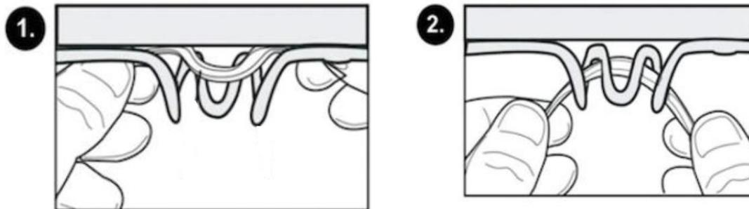
Prenez les boucles du bord supérieur du filet. Accrochez une boucle au-dessus et autour de centre du crochet de l'arceau. Déroulez la boucle pour sécuriser le filet dans le crochet. Répétez cette étape pour le reste des boucles du Filet.
