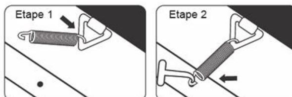
2. Répétez le processus pour chaque ressort (D) en suivant **IMPERATIVEMENT** les schémas ci-dessous en fonction de la taille de votre trampoline.
