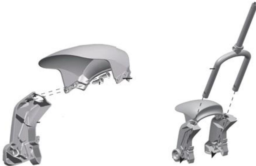
Placez une rondelle et un écrou à l'extrémité de l'essieu avant , insérez l'essieu sur la fourche (au niveau du couvre-roue). Puis placez une rondelle et un embout noir sur l'essieu. Insérez la roue sur l'essieu, placez de nouveau un embout noir + une rondelle sur l'essieu. Faites ressortir l'essieu au niveau du couvre-roue et enfin placez une rondelle et un écrou (voir schéma ci-dessous). Serrez les écrous.
