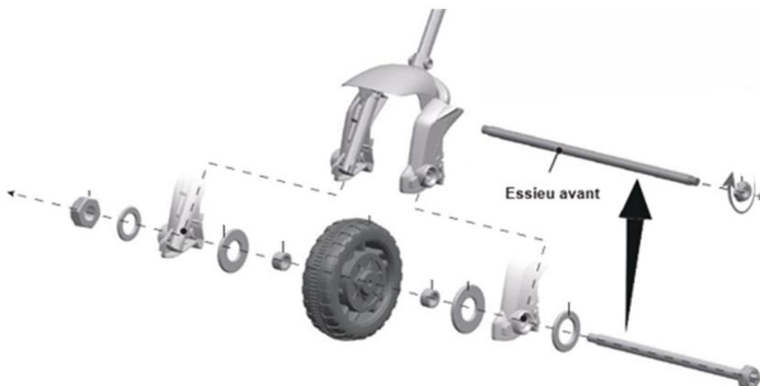
Insérez la fourche dans le trou situé à l'avant du véhicule.
